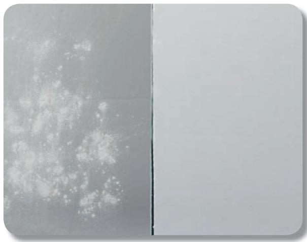
**foto 3** *comparazione visiva tra pannello P3ductal standard e pannello P3ductal careplus sottoposti a luce naturale*
