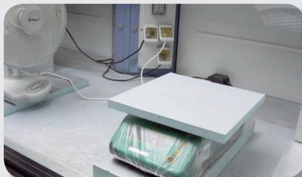
**sequenza 4** dopo l'azione di "sporramento", il campione P3ductal careplus viene sottoposto a un flusso d'aria generato da un ventilatore azionato per 2 minuti a velocità 1 e per due minuti a velocità 2. A fine test il campione risulta praticamente pulito.
