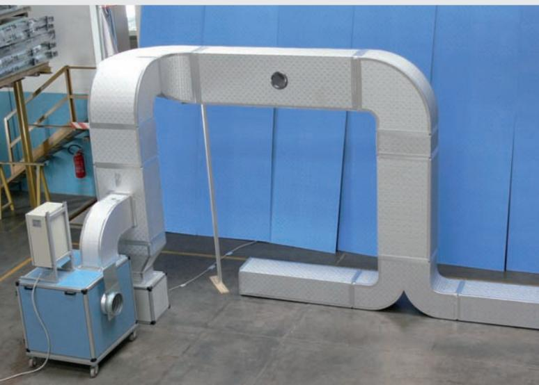
Per questo motivo ai test in laboratorio su campioni di alluminio trattato con coating nanotecnologico a effetto loto, P3ductal care*plus*, ha fatto seguito la sperimentazione su grande scala realizzata mediante un circuito aeraulico sperimentale in cui è possibile effettuare prove comparative simultanee di sporcamento di due differenti tratti orizzontali di canalizzazione a parità di portata d'aria.
