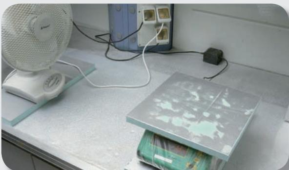
**sequenza 3** dopo l'azione di "sporramento", il campione standard viene sottoposto a un flusso d'aria generato da un ventilatore azionato per 2 minuti a velocità 1 e per due minuti a velocità 2. A fine test il campione presenta ampie zone di sporco residuo.
