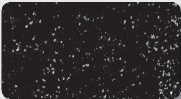
**foto 11** particolare dello sporco residuo "incollato" sul nastro dopo la verifica col taping test sul canale P3ductal standard
