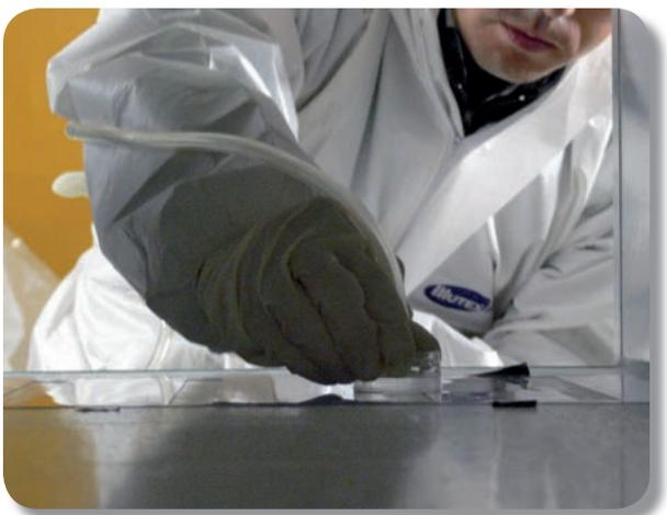
**foto 9** *prelevamento di un campione di particolato depositato all'interno del canale secondo quanto previsto dal NADCA Vacuum Test*
