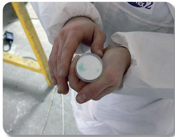
**foto 10** *particolare dello sporco residuo prelevato dall'interno del canale campione in lamiera zincata*
