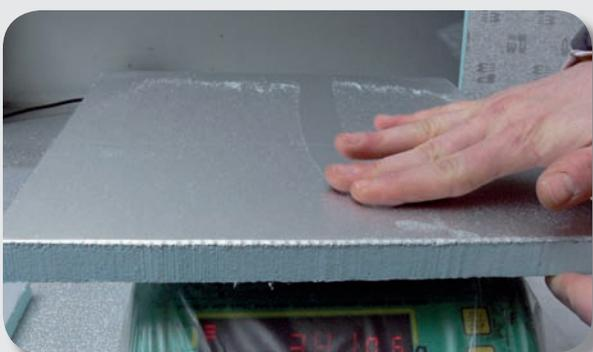
**sequenza 1** il pannello in alluminio standard tende a trattenere parte dello sporco anche dopo l'azione di rotazione manuale.
