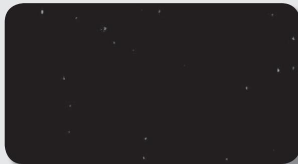
**foto 12** particolare dello sporco residuo "incollato" sul nastro dopo la verifica col taping test sul canale P3ductal careplus
